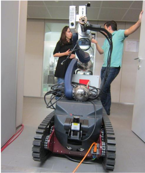
O INESC TEC acolheu, a 11 e 12 de novembro, o primeiro *workshop* de integração do projeto CARLoS (*CooperAtive Robot for Large Spaces manufacturing*), onde se desenvolve um protótipo de um robô manipulador móvel para aplicações de *fit-out*, revestimentos e instalações, dentro de blocos de superestruturas de navios.
